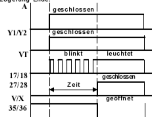
Art1: Der Kontakt A schliesst sich mindestens bis die Verzögerung Ende.
