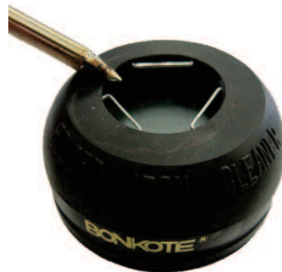
Bei starken Verzunderungen die Lötspitze am runden Drahtstift vorreinigen
